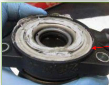
O uso de silicone ou outro agente a base de óleo mineral, danificam as vedações internas dos cilindros causando dilatação ou rompimento das mesmas.
