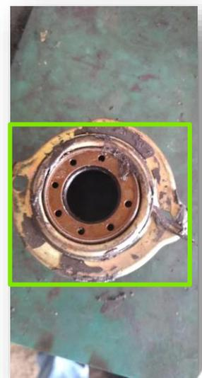
A Valeo possui outras dicas sobre pedal duro e desgaste do tubo guia. No caso desta aplicação, sempre que substituir o kit 228091, verifique com muita atenção, O ESTADO DO TUBO GUIA.
