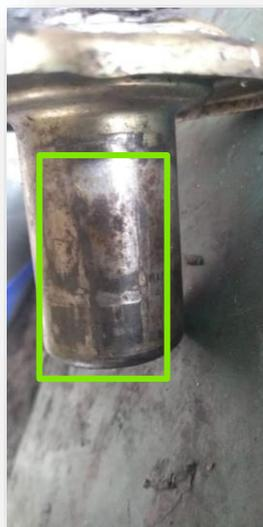
Tubo Guia nestas condições deve ser substituído para não causar o sintoma de pedal duro
